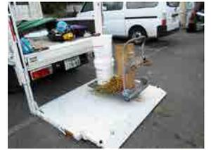
トラックにパワーゲートも取り付けました。機械・材料の積み下ろしに大活躍してくれます。
