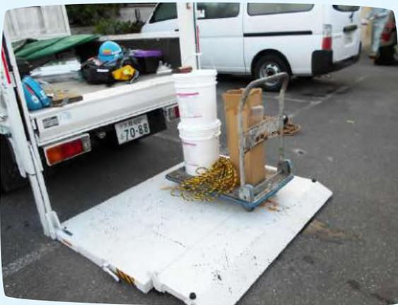
床面剥がし機導入にあたってトラックにパワーゲートを取り付けました。機械以外にも重量のある材料の積み下ろし作業に活躍してくれます。
